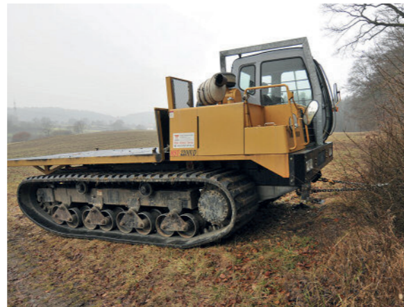
Rechts: Der Morooka-Raupenschlepper wird vom Seil gehalten und somit gesichert.
