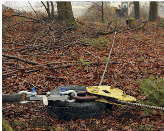
Rechts: Der Morooka-Raupenschlepper wird vom Seil gehalten und somit gesichert.
