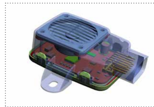
CAD Modell des Gehäuses, welches Schutzart IP 67 erfüllt.
